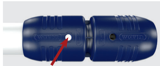
9. ábra: A kupakban található kémlelőnyíláson keresztül ellenőrizhető a cső ütközésig történő betolása
