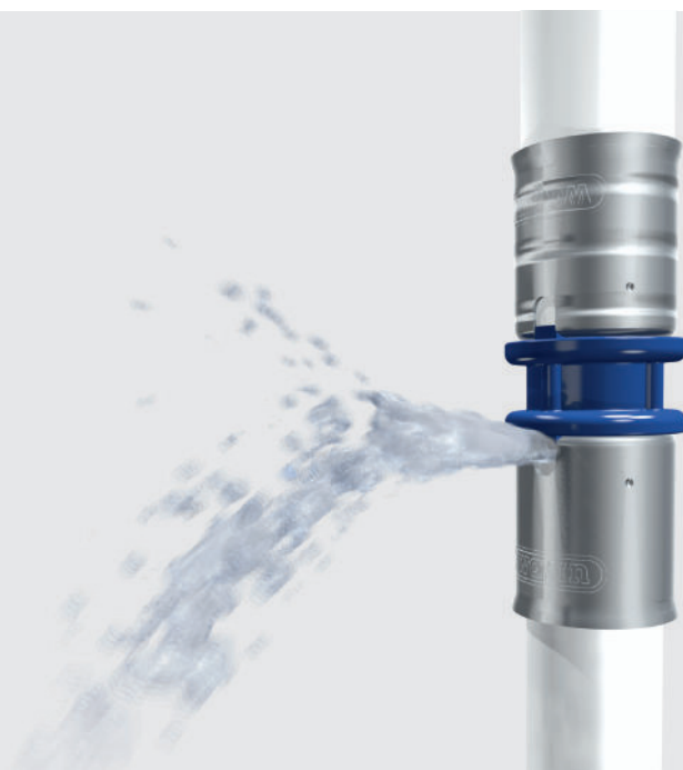
5. ábra: Biztonságot nyújtó, rafinált megoldás: a nyomáspróbánál a szivárgási funkció a le nem préselt kötések láthatóvá teszi
