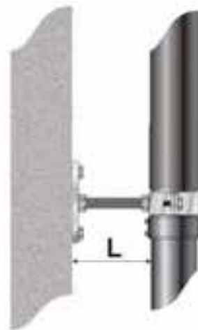
25. ábra: Ejtővezeték rögzítése merev szerkezethez
